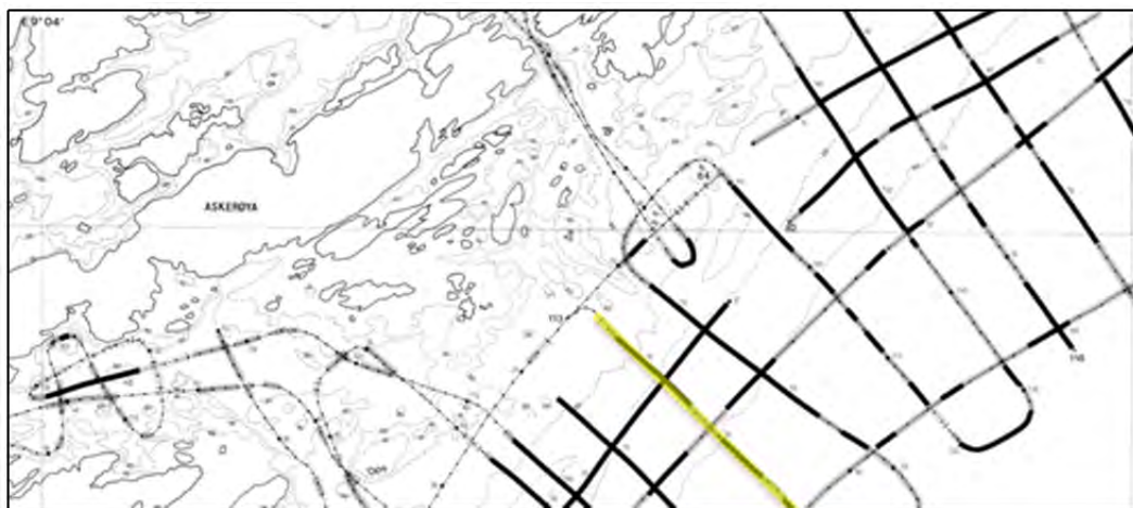
Figur 22. Målelinjer ved utført refleksjonsseismisk profilering ved Askerøya, utsnitt av kart. Mørke felt angir løsmassetykkelse >20m. Linje 13 er angitt med gult, se seismogram i figur 29. 29
